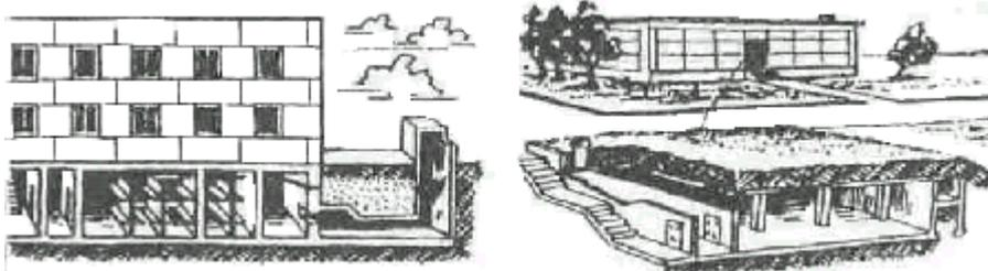
Для оборудования укрытия используются подвалы зданий построенных из кирпича, из сборных железобетонных конструкций или монолитного железобетона (монолитный железобетонный каркас и кирпичные стены) способные выдержать обрушение выше расположенных этажей, способные обеспечивать защиту от воздействия избыточного давления по фронту воздушной ударной волны равного  $0,5 \text{ кгс/см}^2$ , имеющие 2-а и более выходов.
